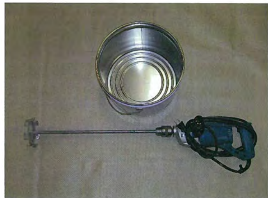
練り混ぜ容器、高速ハンドミキサー(回転数が800rpm以上)
