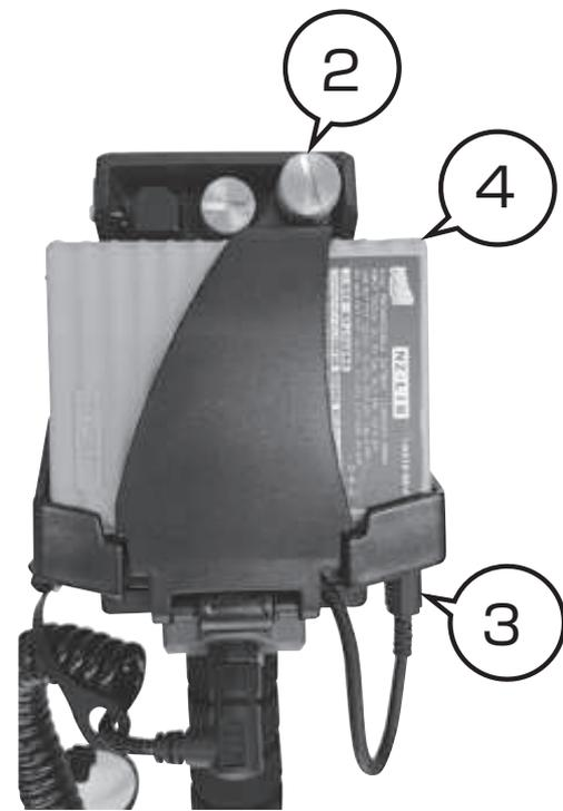
Liバッテリー(NZ-LIB)をセットして②の固定ネジを回して止めます。DCプラグ③を差し込み、**必ずUSBポート④にUSBキャップを取り付けます。**
