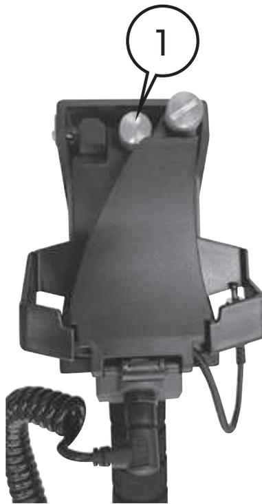
Liバッテリーアダプターを下に押し込みながら、①の脱着ネジを回して止めます。
