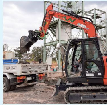
また、バケットの交換がオペレーターの手元作業のみで簡単に完了する点や、現場に転がっているちよつとした物を付属の爪（グリッパ）で手軽に移動させられる点にもメリットを感じています。
